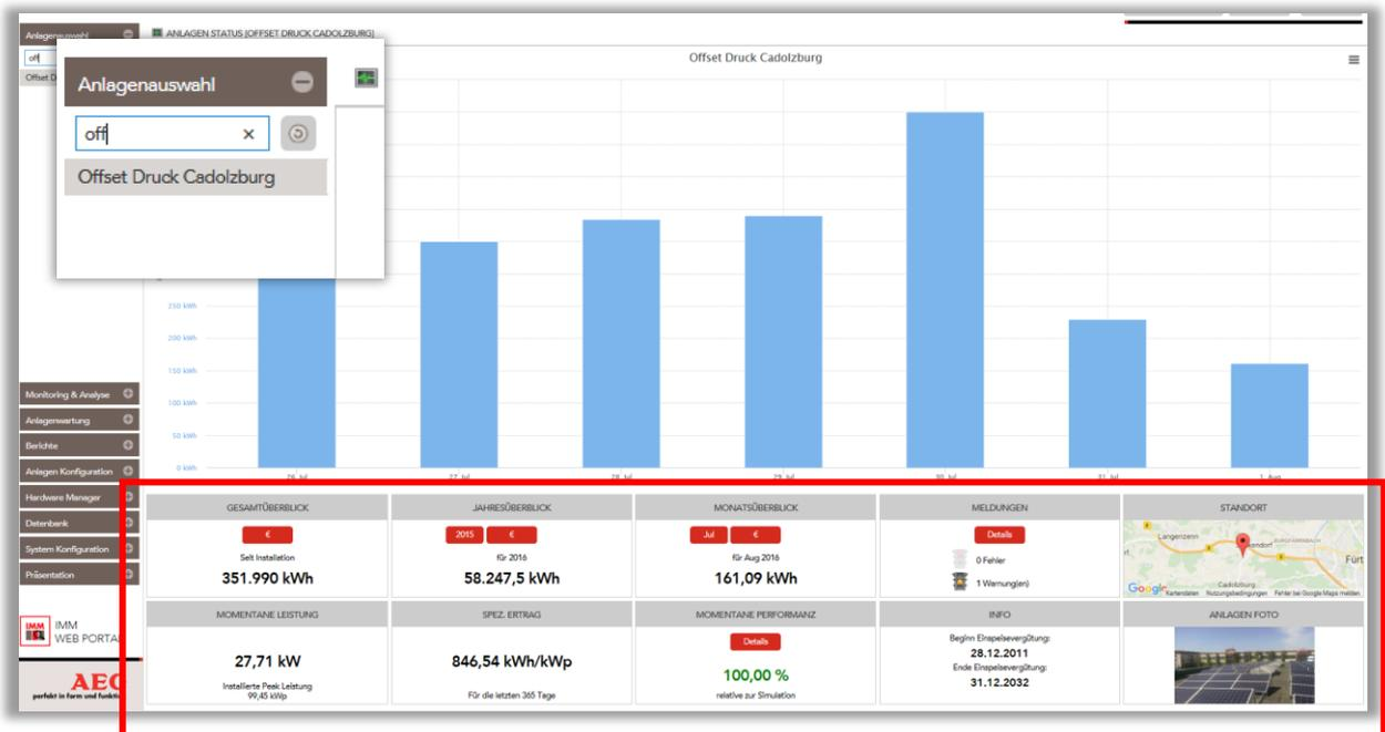
Abbildung 5: Startseite des SunSniffer® Webportals mit markierter Anlagenübersicht und Anlagenauswahl
