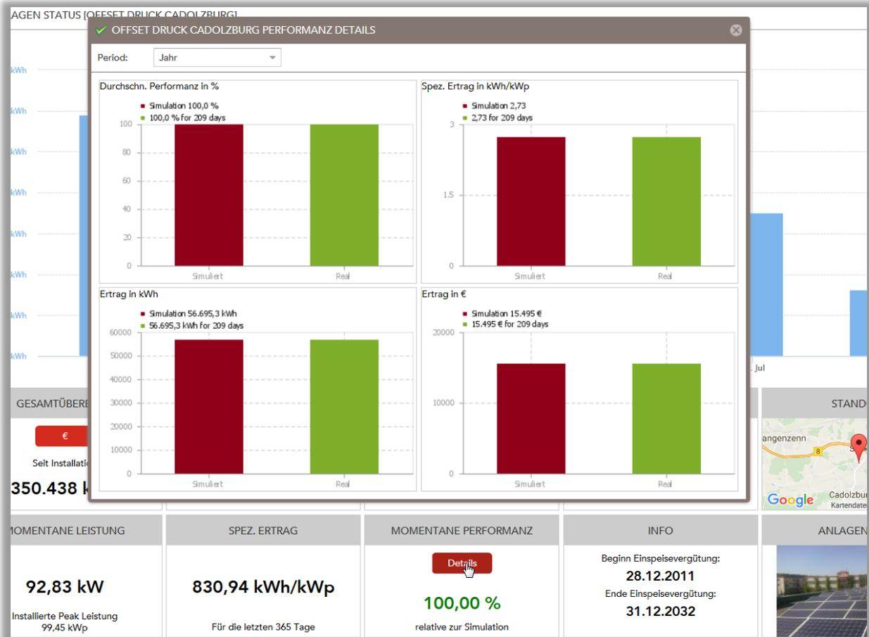
Abbildung 16: Detailfenster zum Performance Vergleich
