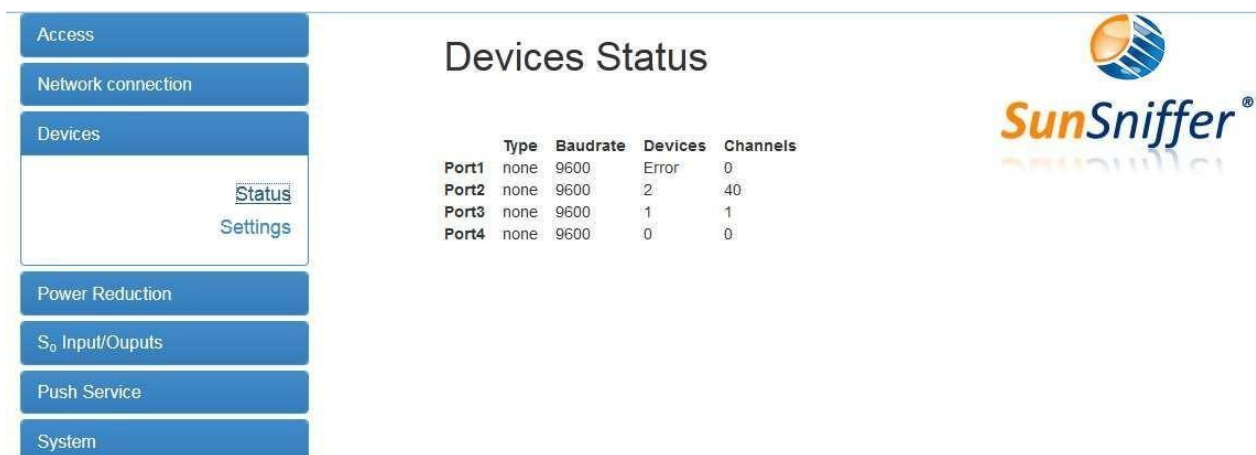
图例 16: 查看网关上每个端口的状态
